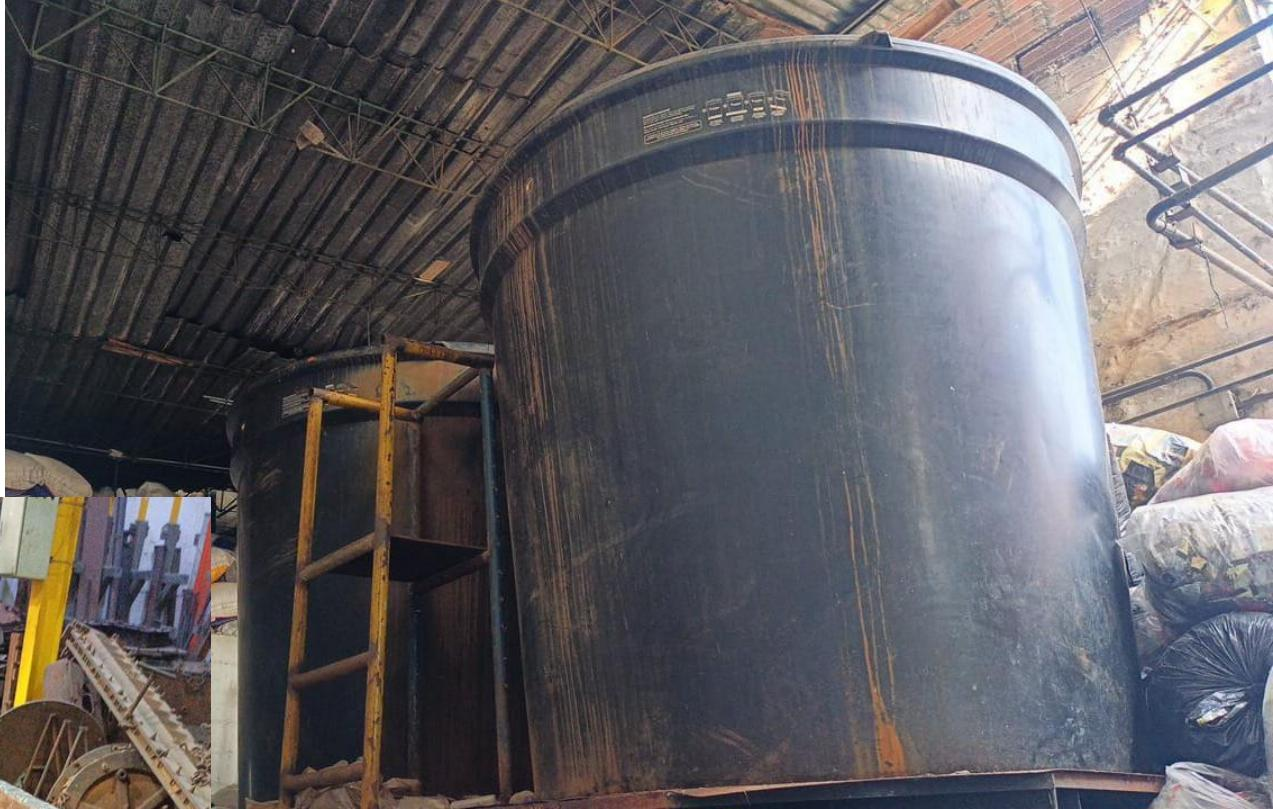
contamos con 2 tanques de enfriamiento de productos que tienen proceso de recirculación, cada uno con capacidad de 6mil litros de agua
