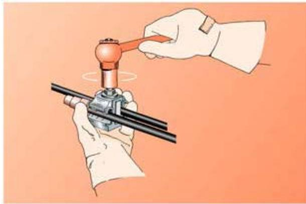
PASO 4: La instalación termina cuando la cabeza fusible del tornillo se quiebra, como se muestra en la gráfica siguiente:
